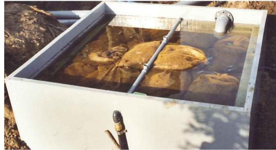
De kokos zorgt ervoor dat het zwevende materiaal tegengehouden wordt. In tegenstelling tot zandfilters is de drukval over een kokosfilter beperkt, maar deze filters kunnen niet worden teruggespoeld. Periodiek (de frequentie is afhankelijk van de belasting van het uitgangswater) moet de kokos uit de filter gehaald worden om gereinigd te worden.
